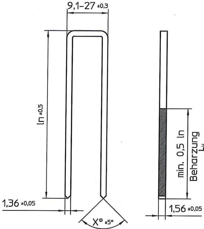
Klammerndraht  $d = \varnothing 1,51 \pm 0,03$
