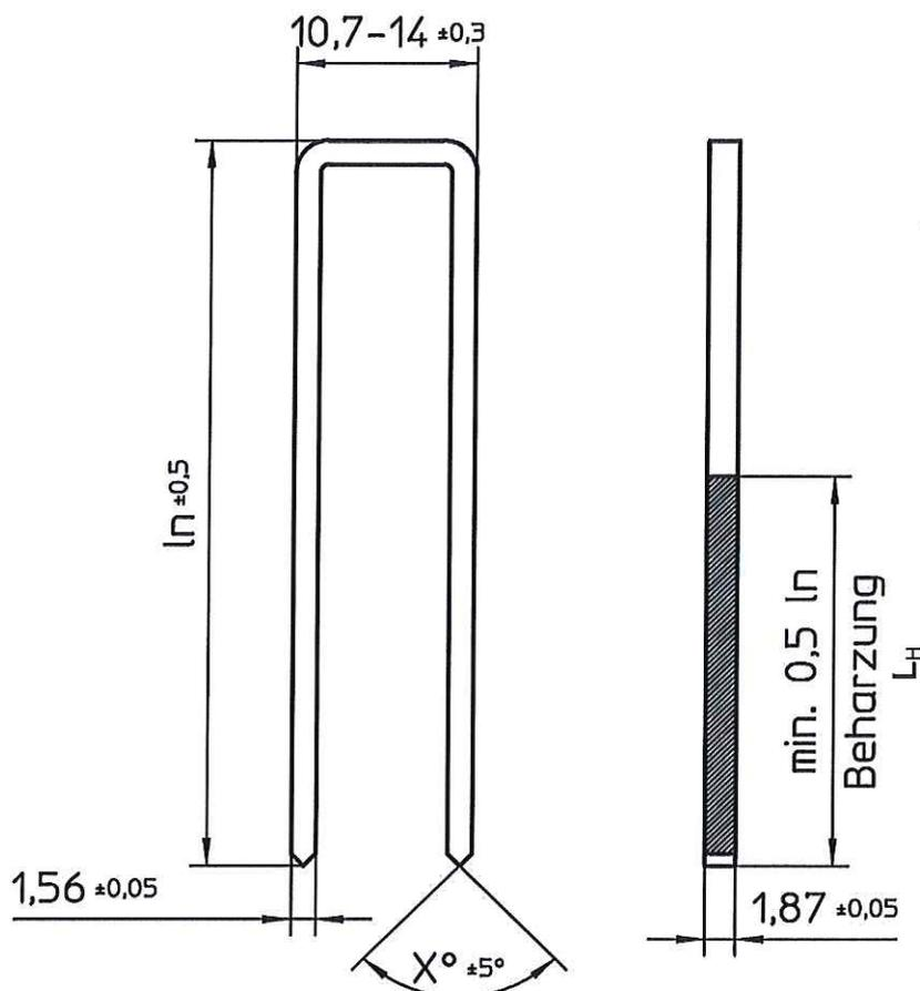
Klammerndraht  $d = \varnothing 1,78 \pm 0,03$
